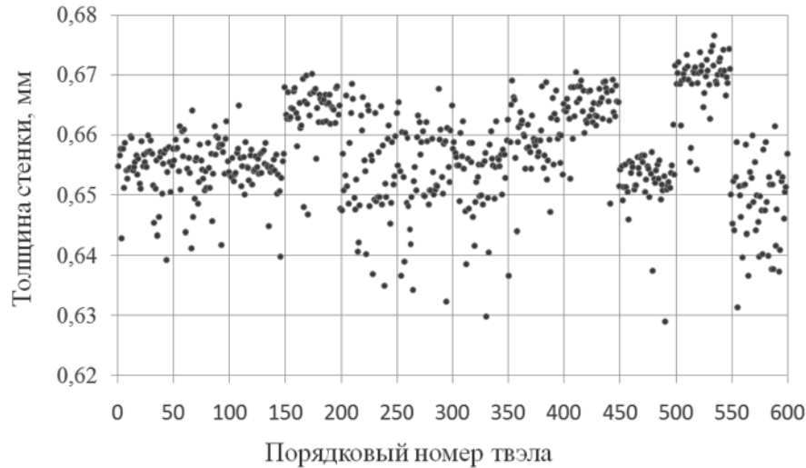
Рис. 5. Флуктуации толщины стенки твэлов ВВЭР-440, измеренных ультразвуковым методом
