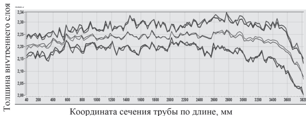
Рис. 5. Пример повторяемости измерений максимальной, средней и минимальной толщины внутреннего слоя трубы от 26.11.2021 г. и 12.12.2021 г.
