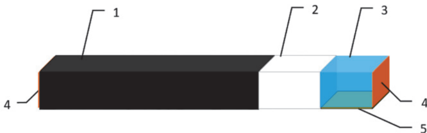
Рис. 1. Конструкция детектора: 1 – светозащитное покрытие; 2 – тефлоновое покрытие; 3 – светопровод из оргстекла; 4 – SiPM; 5 – ZnS:Ag+ 6 LiF
