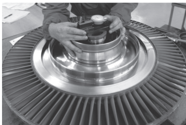
Рис. 2. Диск ГТД с лопатками [2]
