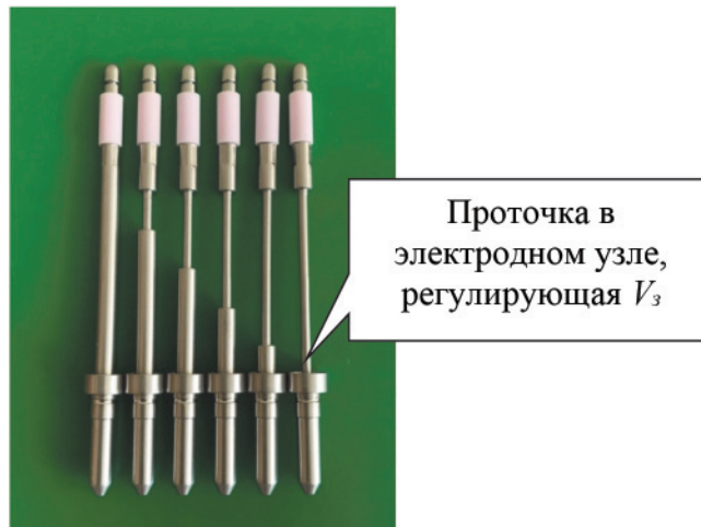
Рис. 2. Фото электродных узлов, демонстрирующее способ регулирования заэлектродного объема V_3
